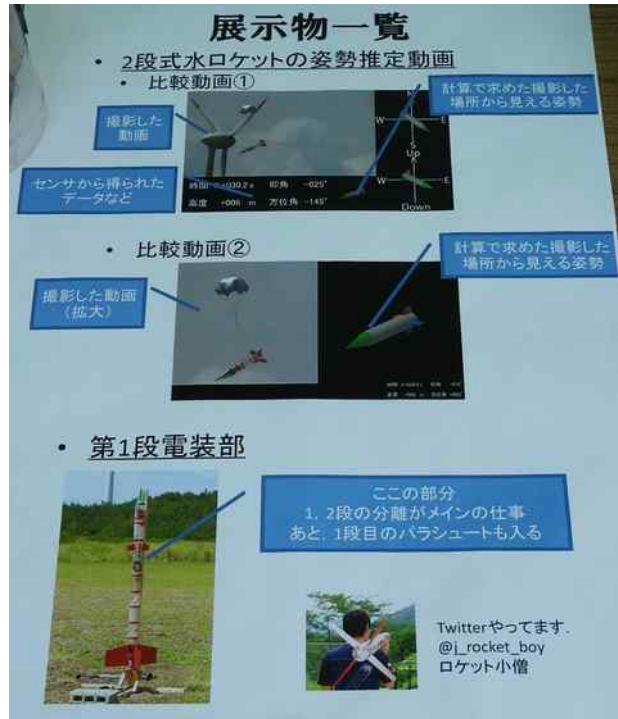
図2. 15 2段式水ロケットの姿勢推定
